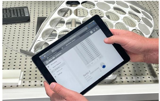
MES-360 Coating Batch, realiza el seguimiento de las lentes durante el proceso de recubrimiento.
