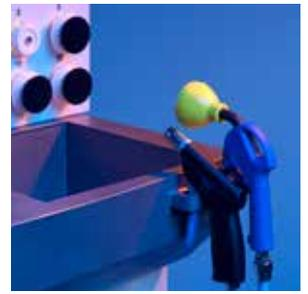
Bereich zum Waschen der Gläser mit Wassersprüher und Druckluft
