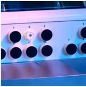
Werkzeugablage mit Anzeigen für Werkzeugauswahl und Auswahl
