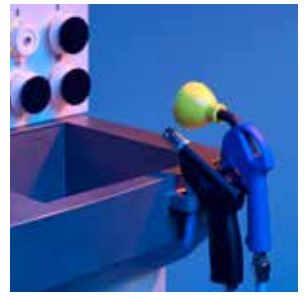
镜片清洗台带喷水枪和压缩气枪
