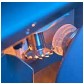
Processo de fresamento rápido com 24.000 RPM.
