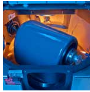
刀具轴与坚固的工件主轴(B轴)轨道排列。
