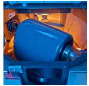
Alinhamento orbital das ferramentas com spindle da lente robusto.
