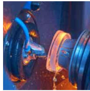
Sistema TTC (Through Tool Cooling) refrigera o ponto de corte da ferramenta.
