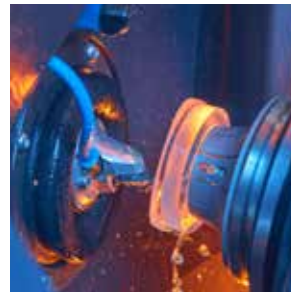
Through Tool Cooling refroidit le point de coupe de l'outil.
