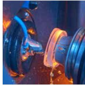
Through Tool Cooling enfría el punto de corte de la herramienta.
