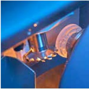
Rápido proceso de fresado con 35.000 RPM, desbastado, biselado y fresado en 10 segundos.
