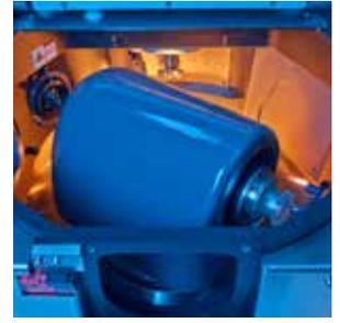
Alineación orbital de los ejes de las herramientas, con un robusto cabezal de trabajo (eje B).
