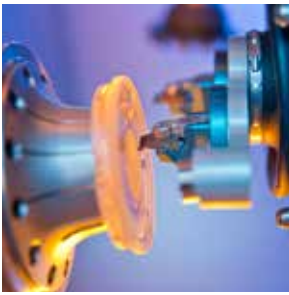
Etapa de acabamento com MCD
