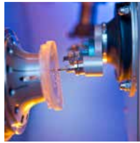
Gravação mecânica da lentes com ferramenta separada
