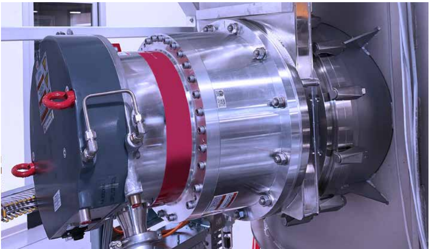
1200-TLX配备2个磁悬浮涡轮泵
