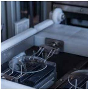
*Kettenloser Glastransport verhindert die Verschleppung von Rückständen zwischen den Kammern*
