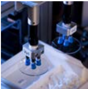
托盘和工单传输系统使镜片保持完美的清洁度,并无需转移工单
