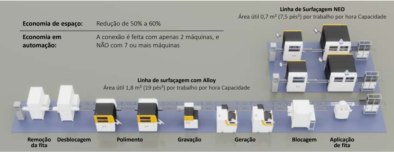
Comparação entre a linha sem blocagem NEO Surfacing em relação a uma linha tradicional de surfaçagem com Alloy
