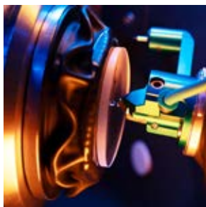
O inovador sistema de fixação por vácuo com pinos se adapta à superfície frontal da lente, fixando e sustentando-a durante o processo de geração
