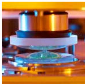
O adesivo curável por UV protege a parte frontal da lente, eliminando o processo de aplicação da fita.
