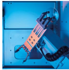
Carga: Robot de 6 ejes que logra una alta precisión
