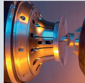
优化的镜片夹具系统用于高速 RPM 加工
