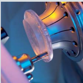
用PCD 粗磨刀具割边及倒角细小镜片的直径
