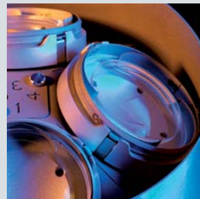
装载在下盘的镜片上作前面或背面减反膜的托架
