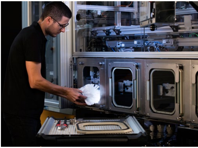
Pouco esforço de manutenção: troca da escova em segundos, apenas uma curta parada para substituição do suporte da lente
