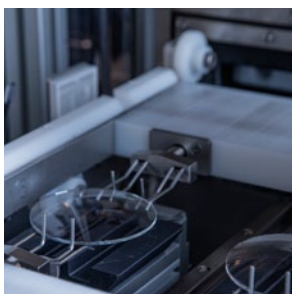
O sistema de transferência da lente sem corrente evita contaminação cruzada da câmara
