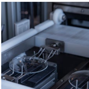
Le système sans chaîne de transfert de verres empêche la contamination inter-chambres
