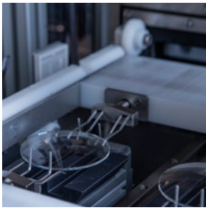
El sistema de transferencia de los lentes sin cadena evita la contaminación cruzada entre las cámaras
