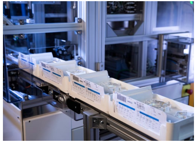
La máquina se ajusta a las alturas de las cintas transportadoras estándar
