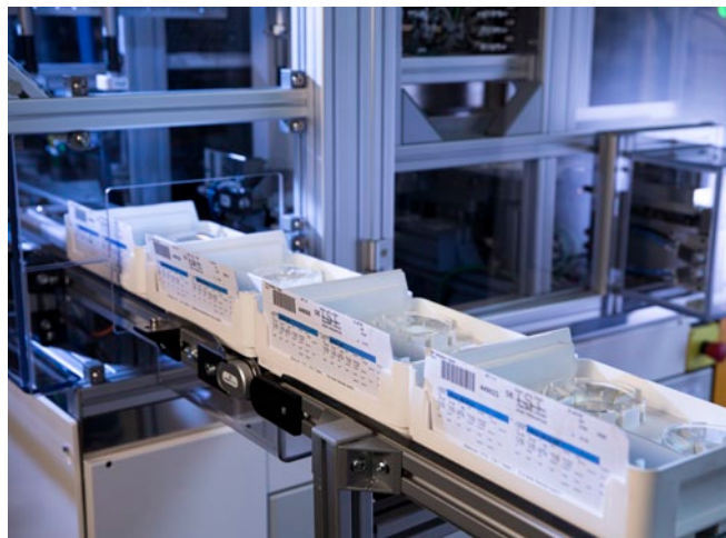
该机器适合标准传送带高度
